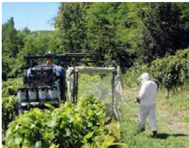
Foto A Prototipo ideato da VitEn per la distribuzione dei fitofarmaci in vigneti sperimentali
