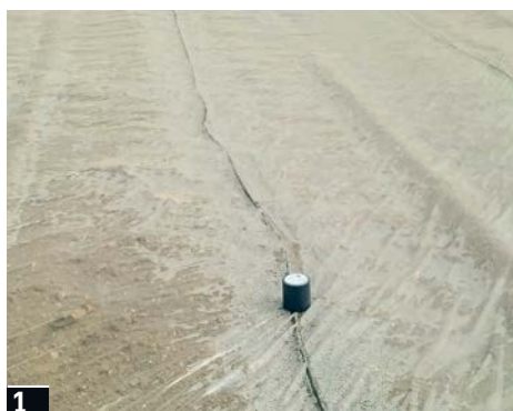
Foto 1 Prova Vittoria 2020. Nematool installato per il monitoraggio della solarizzazione.
